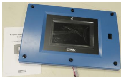
134748 DOL 2400, 10" FP Большая панель в сборе Дисплей и ЦПУ модуль входят в комплект.
