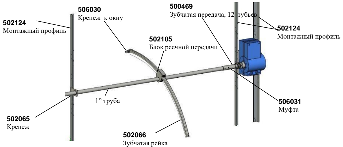
432064 DA 75 Привод для туннельной двери с реечной передачей, 24В
